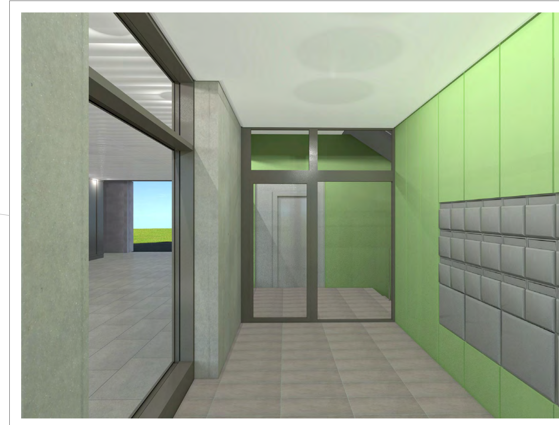
Variante hall en béton brut et un mur de la cage en Argolit
