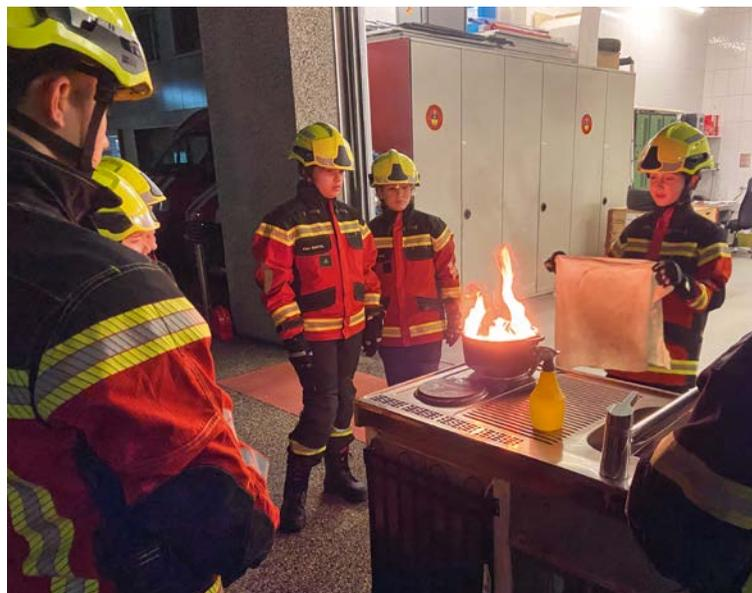
de l'eau au contact de l'huile. Cette dernière se retrouve elle-même expulsée en gouttelettes qui, au contact de plus d'oxygène, s'enflamment soudainement, créant un *boil-over* sous la forme d'une boule de feu extrêmement dangereuse !
